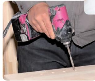
幅や大きさを図面で確認し、壁面収納棚のパーツに穴あけ作業を施す。
