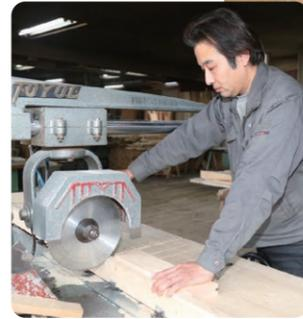
墨付けに合わせ機械で切りそろえる。新人にはまず各種機械の操作方法から教えている。
